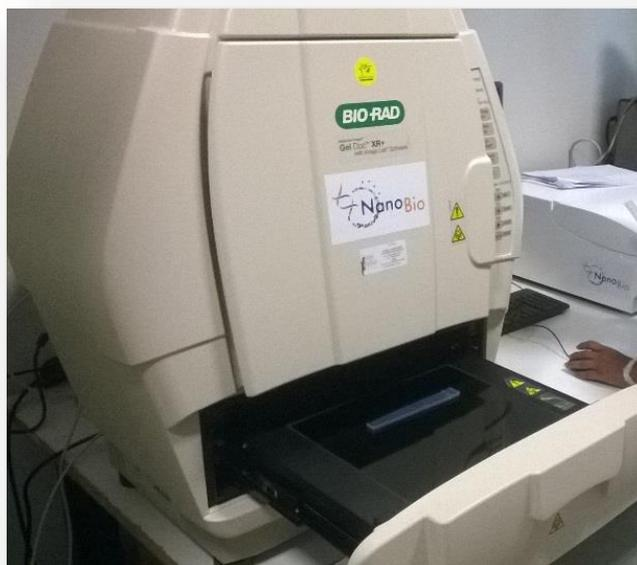
*Figure 81: Lecteur transilluminateur utilisé dans la révélation des produits d'amplification PCR*
