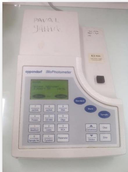
*Figure 91: Spectrophotomètre Eppendorf BioPhotometer ® utilisé dans la mesure de la concentration de l'ADN extrait*
