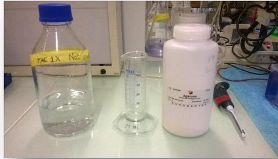
*Figure 77: Solution de TAE et poudre commerciale de gel d'agarose utilisés dans la préparation du milieu de migration*
