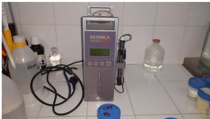
Figure 42 : EKOMILK utilisé pour l'analyse physico-chimique du lait (Photo personnelle, ITELV 2016)
