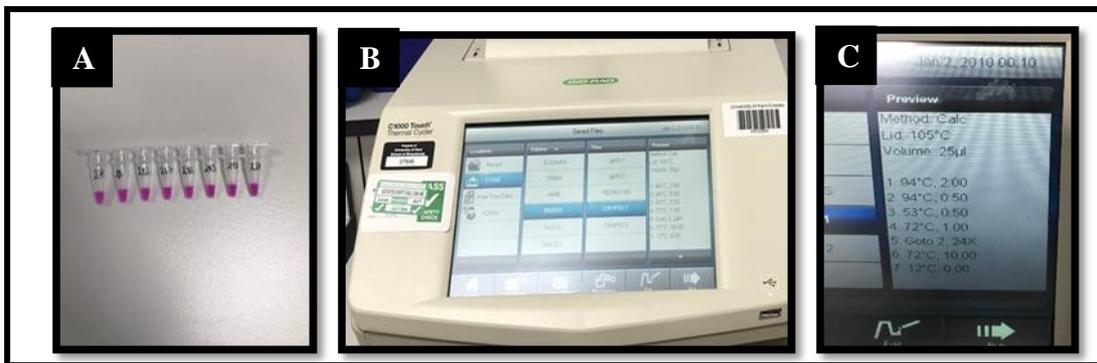
**Figure 16** : Préparation de la PCR primaire (A: mélange de PCR (mastermix + ADN) B et C: programmation du thermocycleur dans la 1ere phase de la PCR) (Photo personnelle, 2020).
