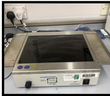
**Figure 19:** Transluminateur des UV utilisé lors du découpage des fragments du gel d'agarose positifs (photo personnelle, 2020).
