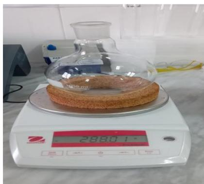
**Photo13** : Séchage et pesage du ballon pyrex après évaporation du solvant. (**Photo personnelle, 2022**)
