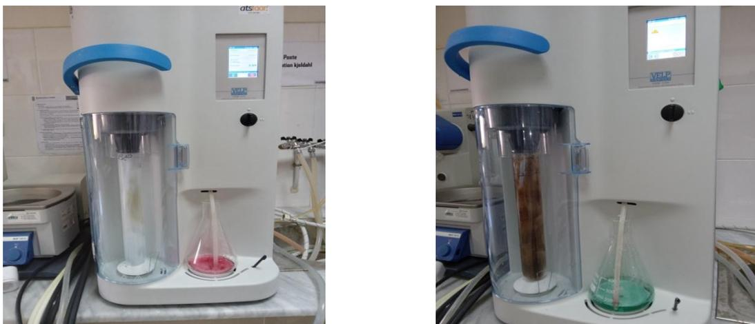
**Photo15** : Distillation kjeldahl des échantillons.(Photo personnelle, 2022)
