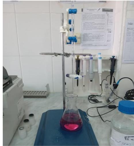
**Photo16** : Titrations des échantillons par acide chlorhydrique(HCL). (Photo personnelle, 2022)
