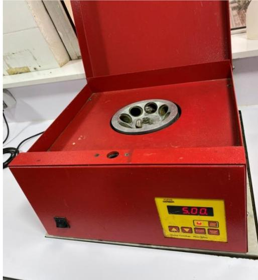
**Figure N°6:** Mesure de la teneur en matière grasse par une centrifugeuse (Photo personnelle)
