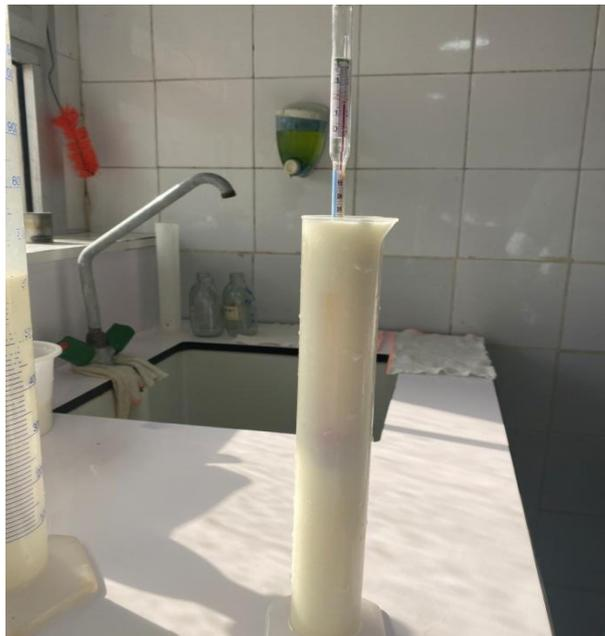
**Figure N°4:** Mesure de la densité du lait cru à l'aide du lactodensimètre (Photo personnelle)
