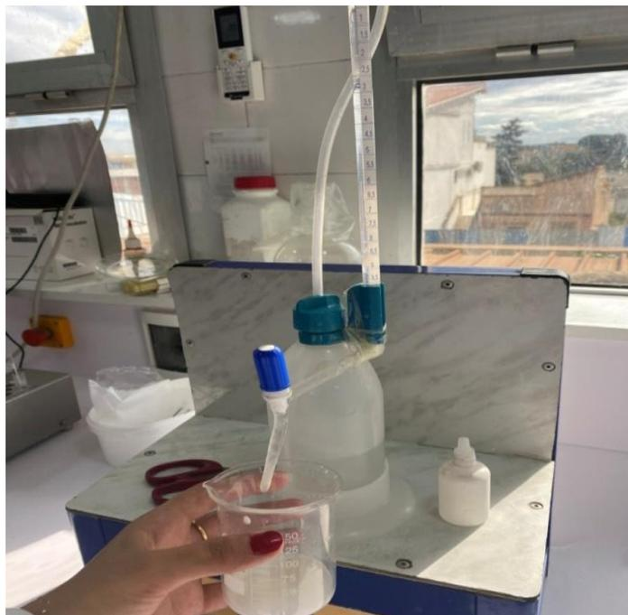
**Figure N°5:** Dispositif pour la mesure de l'Acidité titrable (Photo personnelle)
