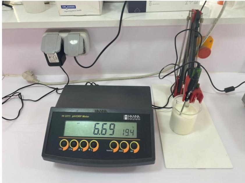
**Figure N°2:** Mesure du pH par un pH mètre (Photo personnelle)
