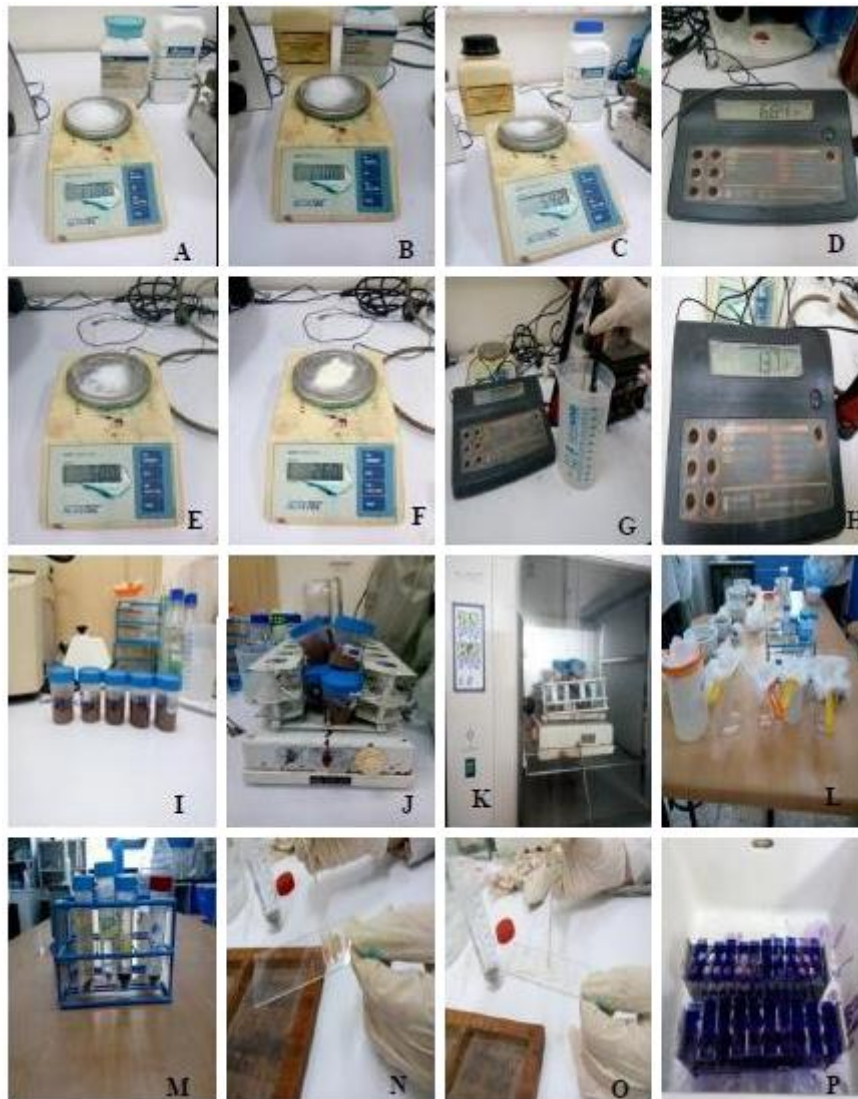
Figure 15 : étapes de la digestion enzymatique, pesée du \text{Na}_2\text{HPO}_4 \cdot 2\text{H}_2\text{O} (A), pesée du NaCL (B), pesée du \text{NaH}_2\text{PO}_4 \cdot 2\text{H}_2\text{O} (C), ajustement du pH de la solution PBS (D), pesée du NaCL (E), pesée de la pepsine (F), ajustement du pH de la solution de digestion (G et H), mélange du broyat et de la solution de digestion (I), agitateur magnétique (J), incubation (K), filtration des échantillons (L), échantillons après centrifugation (M), étalement du frottis (N et O), coloration des lames au MGG (P) (Redjimi et Fettar, 2021)
