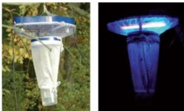
Figure 20 : Piège utilisé pour la surveillance des *culicoïdes* (Balenghien et Delecolle, 2009)
