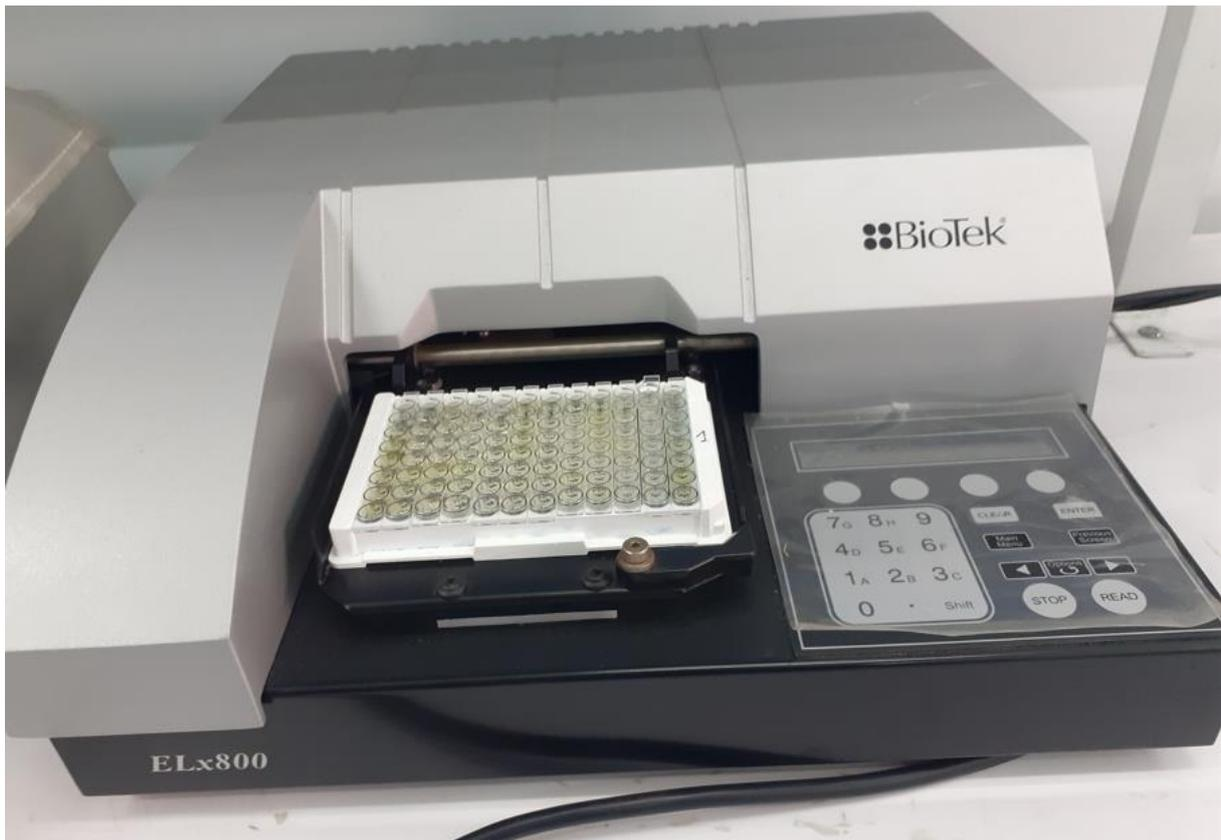
Figure 9 : Densités optiques (DO) dans chaque puits en train d'être mesurées à 450 nm à l'aide d'un lecteur ELISA (Source : photo personnelle).
