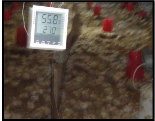
**Figure 07 :** Thermomètre couplé à un hygromètre
