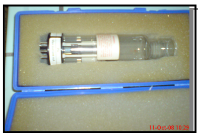
Figure 5 : Lampe à cathode creuse (Plomb). Figure 6 : Lampe à cathode creuse (Cadmium).
