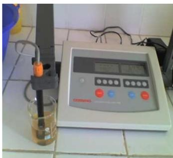
**Fig. 15: Conductivimètre et pH mètre CORNING 442.**
