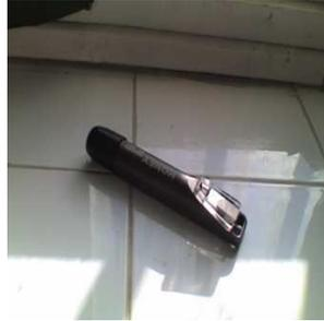
**Fig.14:** Refractomètre manuel (Honey Tester NEOPTA).
