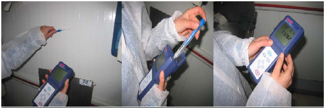
Figure18: Les étapes d'écouvillonnage de surface avec un ATPmètre.
