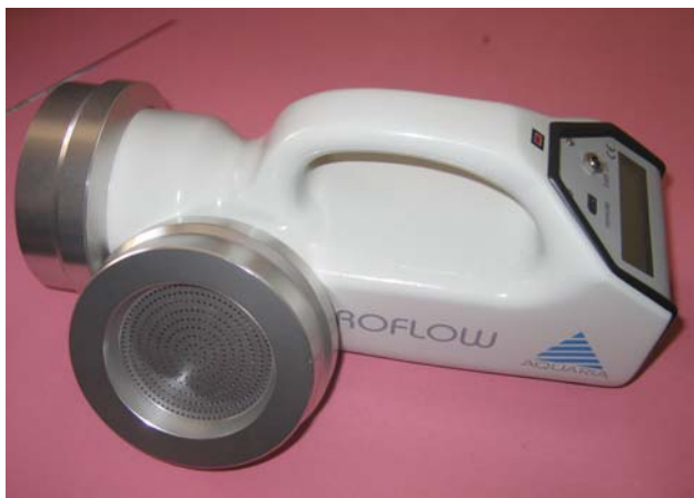
Figure15: Aérobiocollecteur MICROFLOW AQUARIA (photo personnelle).
