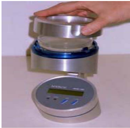
Figure 9 : Aérobiocollecteur MASS-100 de type impacteur ( WIRTANEN, GUN et al, 2002 ).
