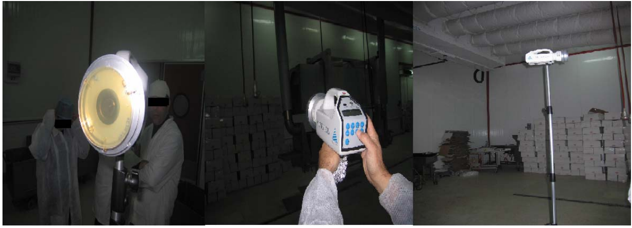
Figure 16 : Les différentes étapes de prélèvements d'air à l'aide d'un aérobiocollecteur (photo personnelle).
