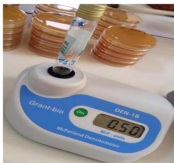
**Figure 10** : Mesure de la turbidité à l'aide d'un densitomètre
