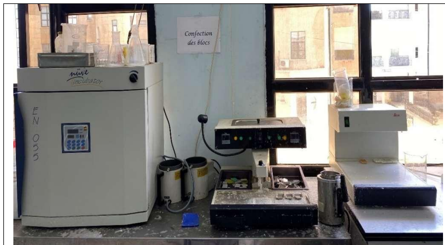
Figure 21 : Etuve, station de confection de blocs et plaque refroidissante (photo personnelle).
