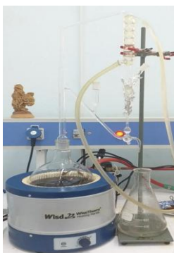
Figure n°8: Dispositif d'extraction de l'huile essentielle (Photo originale, 2024)
