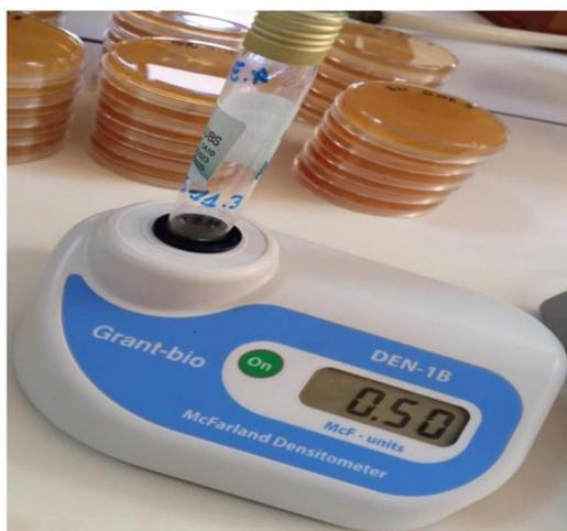
**Figure 8 : Mesure de la turbidité à l'aide d'un densitomètre
