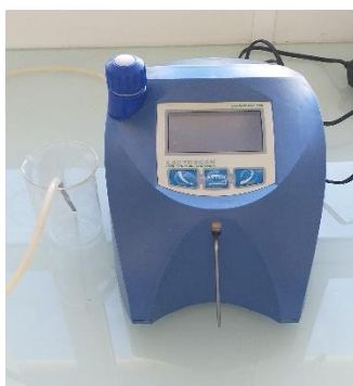
Figure 19 : LACTOSCAN utilisé pour l'analyse physico-chimique du lait (Photo personnelle, l'ENSA El Harrach, Alger)
