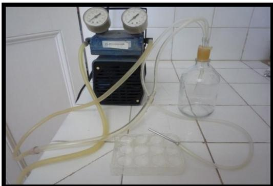
**FIGURE 11** : Dispositif d'aspiration de la gélose pour créer les puits
