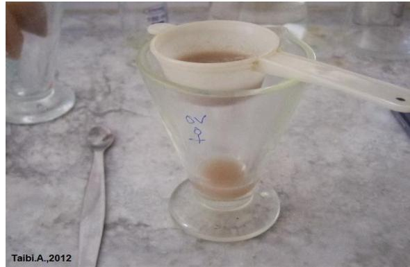
**Figure 22:** Filtration du digestat
