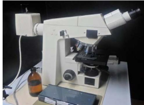
**Microscope à fluorescence utilisé pour la lecture des lames IFAT (Axioskop)**
