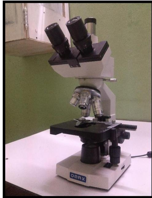
Photo N° 6: microscope photomicroscopique OMAX utilisé pour l'examen des frottis sanguins
