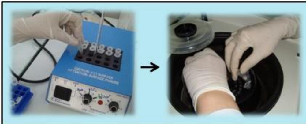
Figure 24 : Deuxième incubation au bain sec et la centrifugation des échantillons (Personnelle, 2011)
