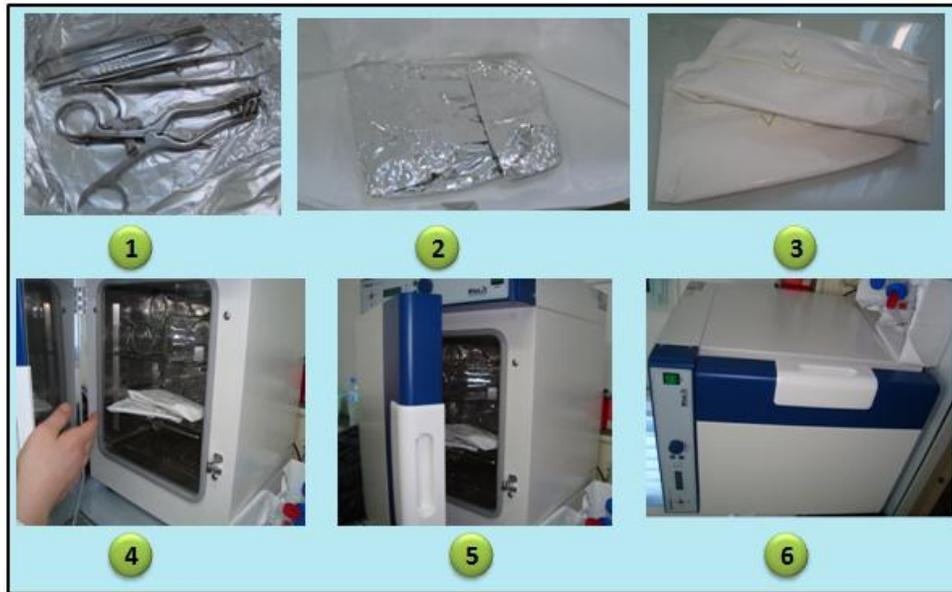
**Figure 10 :** Désinfection du matériel par autoclavage (Personnelle, 2011)
