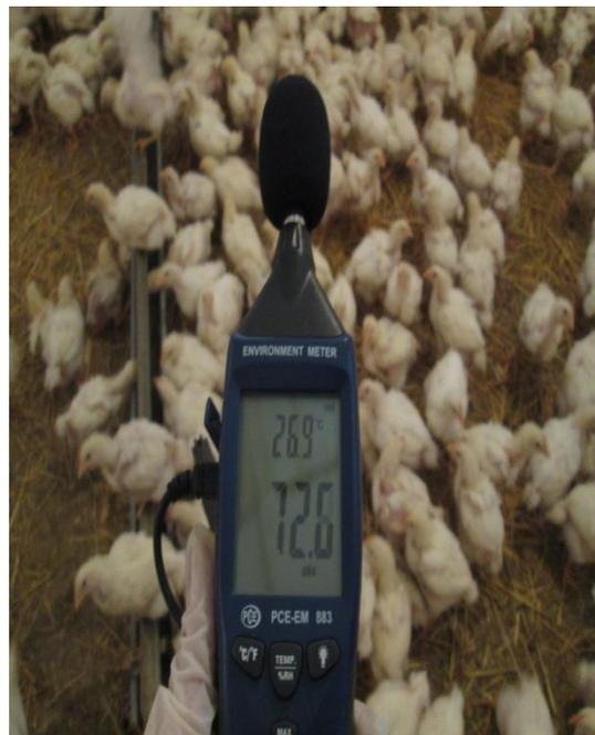
**Photo 1 et 2. Mesure de la température et de l'hygrométrie à l'aide de l'appareil « Environment Meter ».**
