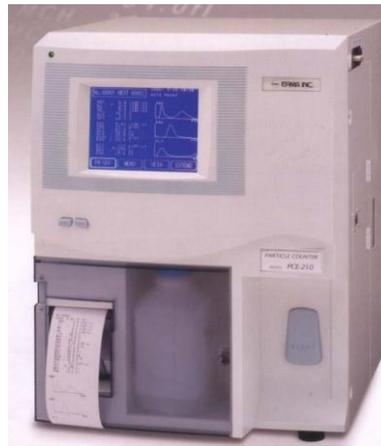
**Figure 12.** Analyseur automatique utilisé pour la mesure des paramètres sanguins (ERMA PCE-21 ON)
