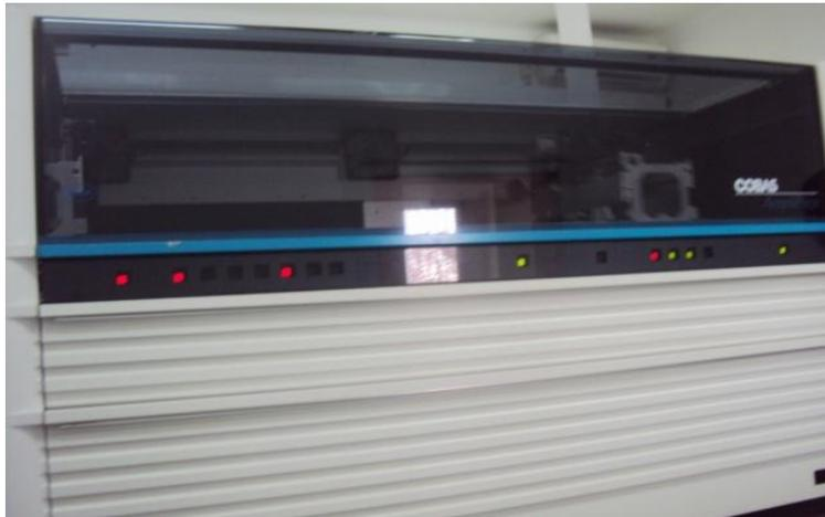
**Figure16: COBAS : Extracteur et amplificateur en temps réel**
