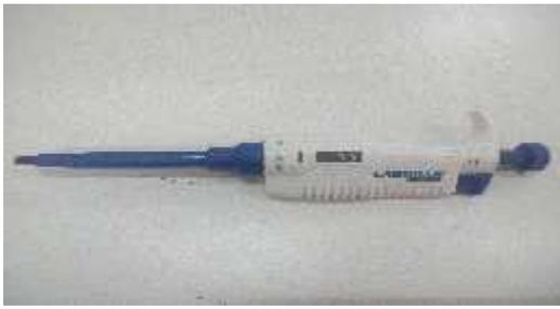
**Photo1** : Micropipette de 0,1 ml
