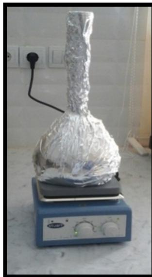
**Figure 9 : Fiole recouverte par l'aluminium et mis sous agitateur lors de l'étape de la macération**
