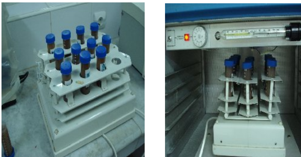
Figure 06 : Tubes contenant le broyat et le flux digestif(A), Tubes déposés dans une étuve sous agitation(B). (Originale, Laboratoire de Parasitologie Mycologie – ENSV – Alger, 2008)
