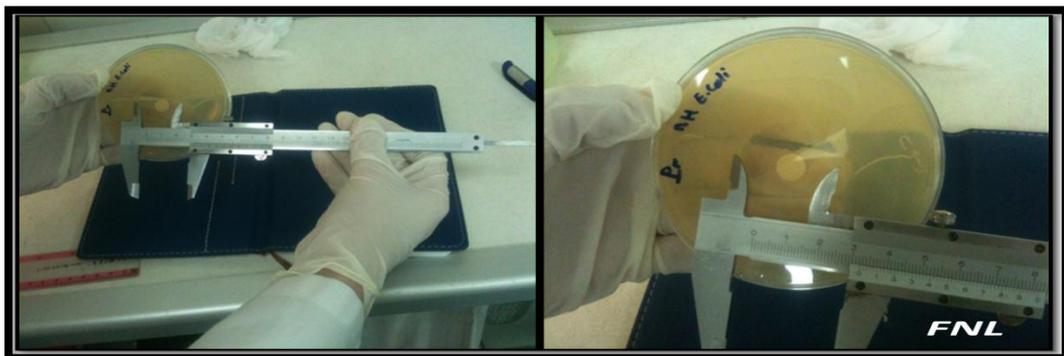
Figure 37 : La mesure du diamètre d'inhibition (Ph.p).
