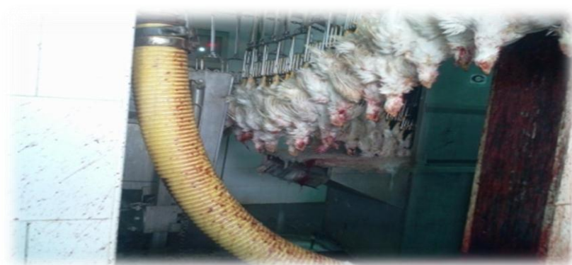
Figure 7: Echaudage automatique (photo personnelle)
