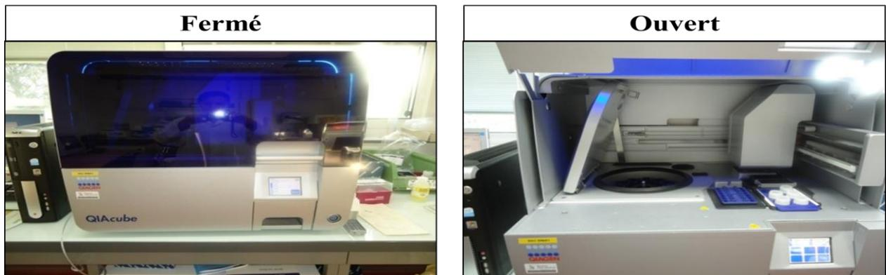
Figure 12 : Photo de l'automate d'extraction Qiagen-Qiacube
