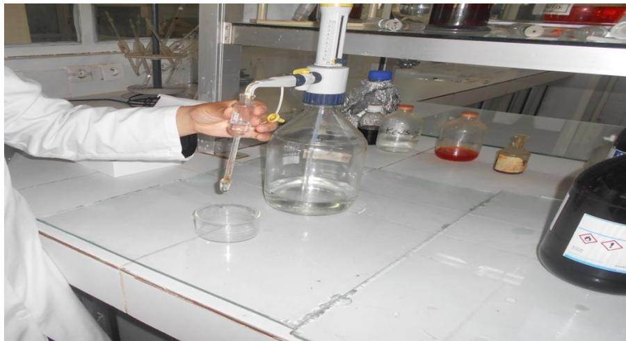
**Figure 9 : Introduction de l'acide sulfurique dans le butyromètre (photo personnelle).**
