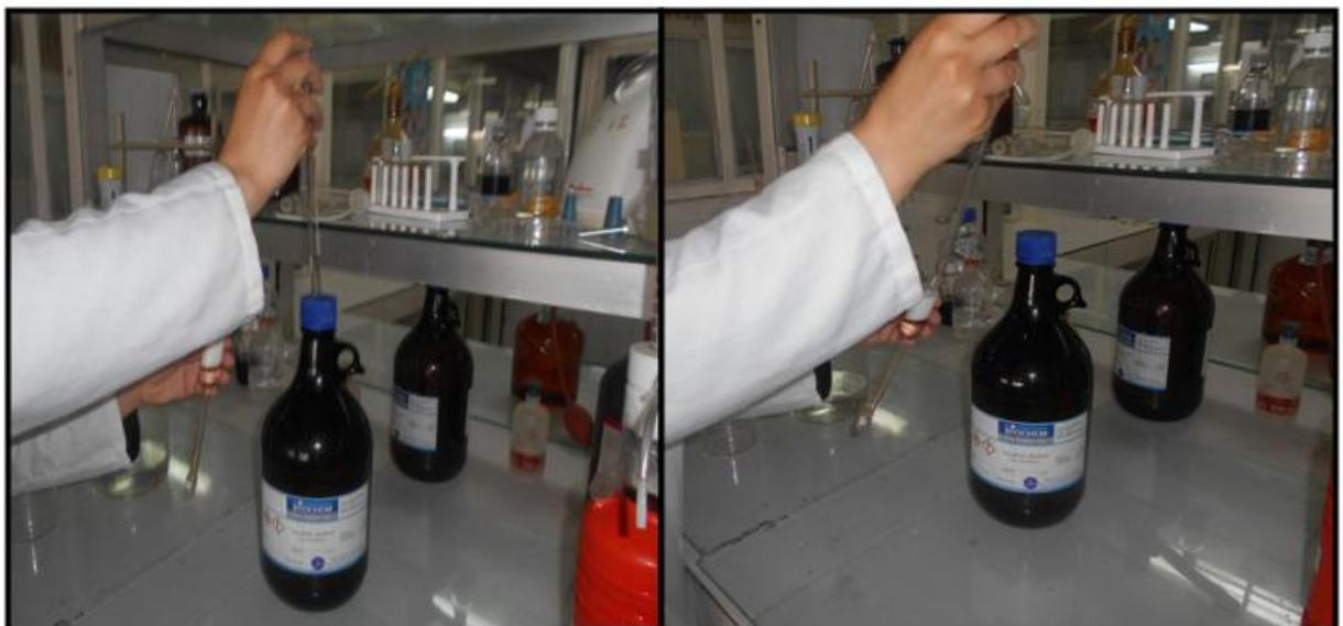
**Figure 11: Introduction de l'alcool amylique pur dans le butyromètre (photo personnelle).**
