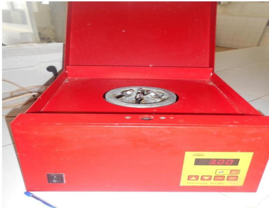
**Figure 13 : Centrifugation des butyromètres (photo personnelle).**
