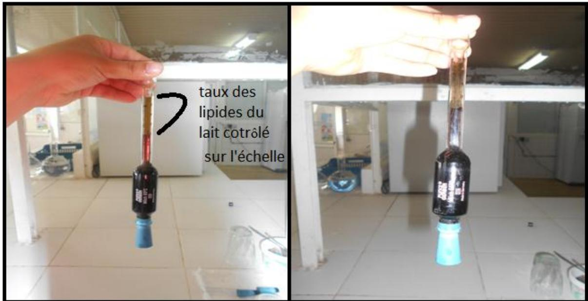
Figure 14 : Lecture du taux de la MG sur le butyromètre (photo personnelle).
