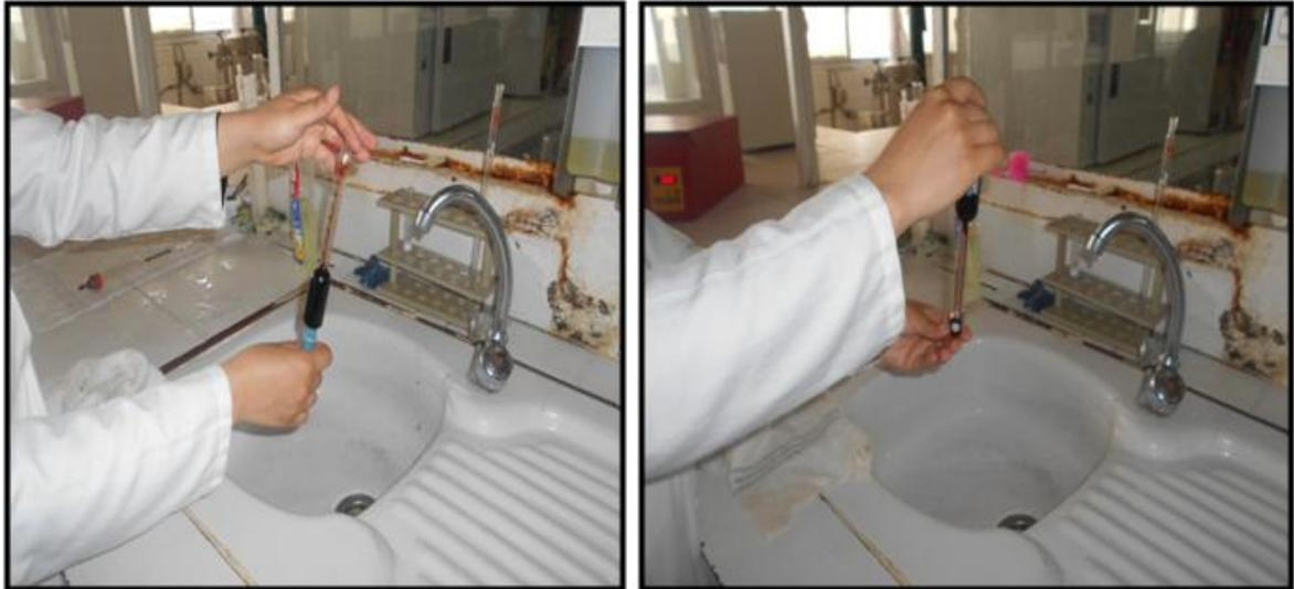
**Figure 12 : Homogénéisation du contenu de butyromètre (photo personnelle).**
