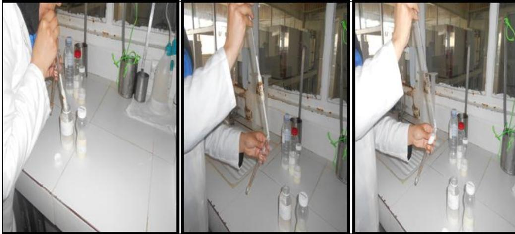
**Figure 10 : Introduction du lait dans le butyromètre (photo personnelle).**
