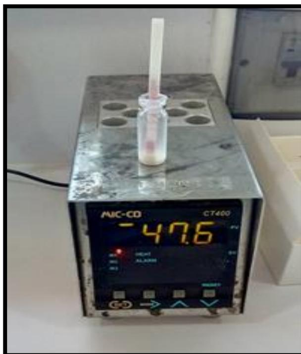
**Figure N°17 : Recherche des résidus d'antibiotiques dans le lait cru (Beta Star Combo)**
