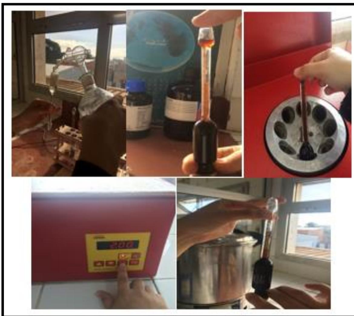
**Figure N°09** : Mesure de la matière grasse par la méthode acido-butyrométrique
