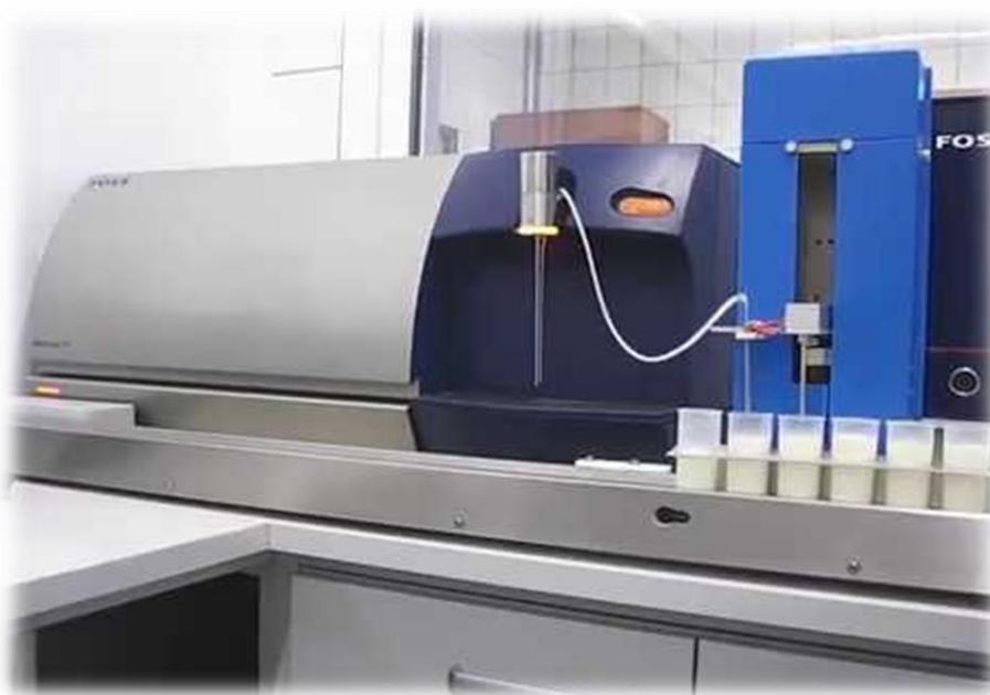
**Figure n°13 : L'appareil de l'analyse du lait (MilkoScan™ FT1)**
