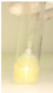
Photo 11 : L'échantillon de pommade après le test de centrifugation.
