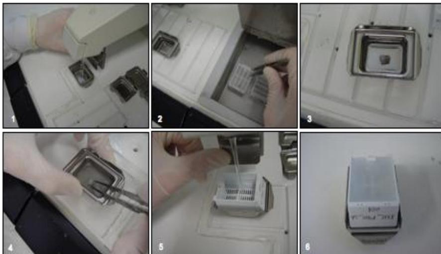
**Photo n<sup>o</sup>3** : étapes d'enrobage d'un échantillon de tissu.
