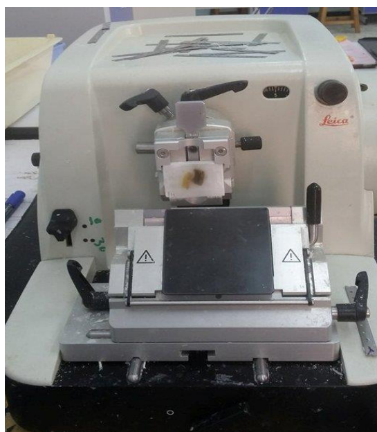
Figure 5 : Microtome (photo personnelle ENSV)
