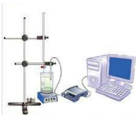
**Figure III.7 : montage de la titration potentiométrique assistée par micro-ordinateur.**
