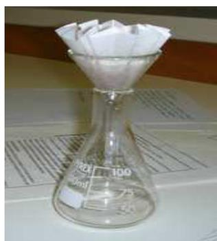
**Figure III.3** : photographie du Dispositif de filtration : (Papier filtre Wattman n°1, Entonnoir, Erlenmeyer).
