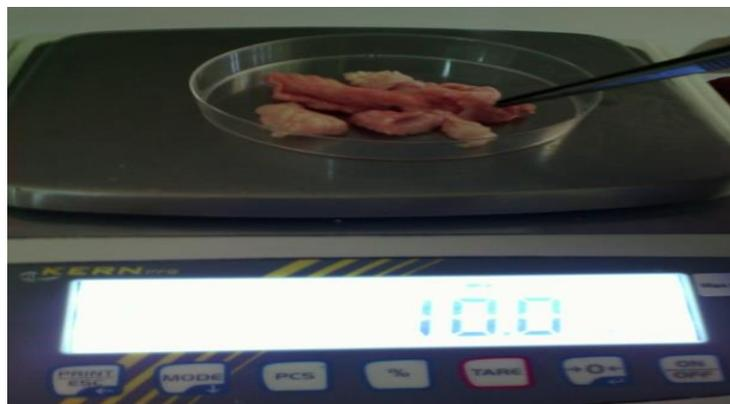
**Figure 06 : Pesée des échantillons (photo personnelle).**
