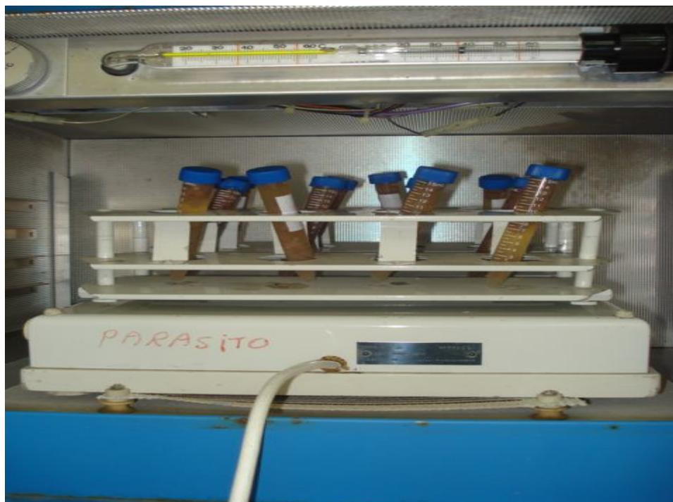
**Figure 07 :** Tube contenant le broyat et le flux digestif déposés dans une étuve sous agitation (Originale, Laboratoire de parasitologie mycologie – ENSV- Alger, 2009)
