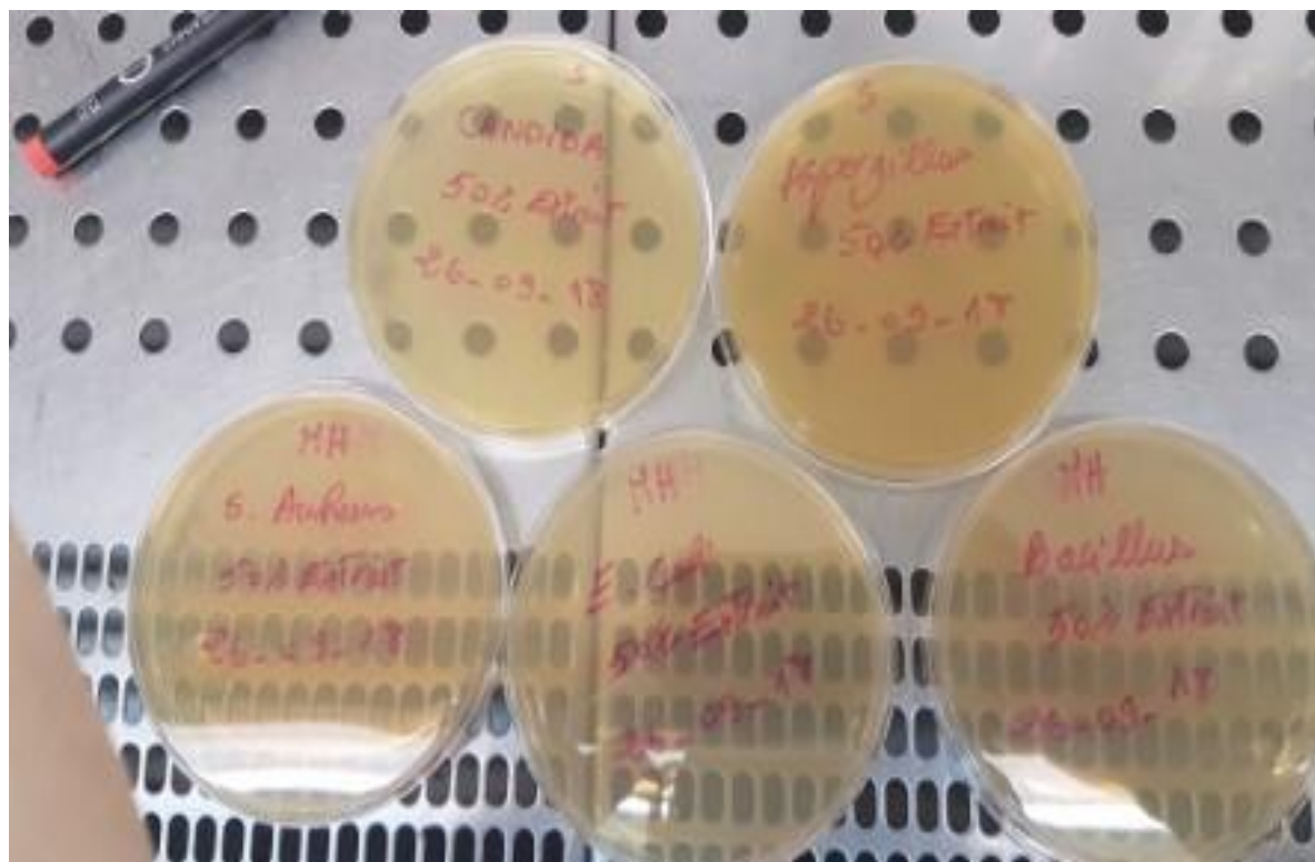
Figure 7 : technique d'ensemencement des bactéries et levures en milieu de culture (photos personnelles, 2018)
